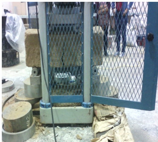
Figura 2: Vista fotográfica de la prueba de compresión de la muestra de adobe. Laboratorio de suelos de la Facultad de Ingeniería Civil y Arquitectura-UNHEVAL
