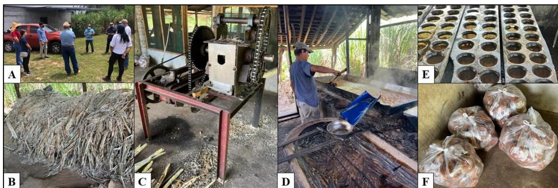
**Figura 1.** Producción artesanal de panela en Tinajas: A) Reunión con el productor; B) Bagazo de caña utilizado como combustible; C) Trapiche de hierro; D) Cocción del guarapo; E) Moldes artesanales de madera; F) Panela embolsada. Fotos: R. Collantes.
